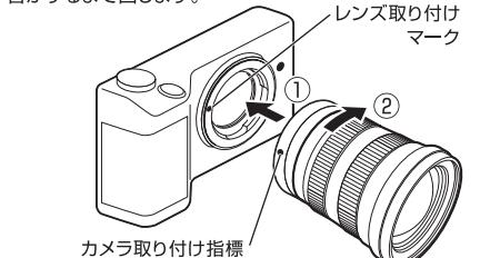
※必ずレンズにマウントアダプターを取り付けてから、カメラに取り付けてください。
